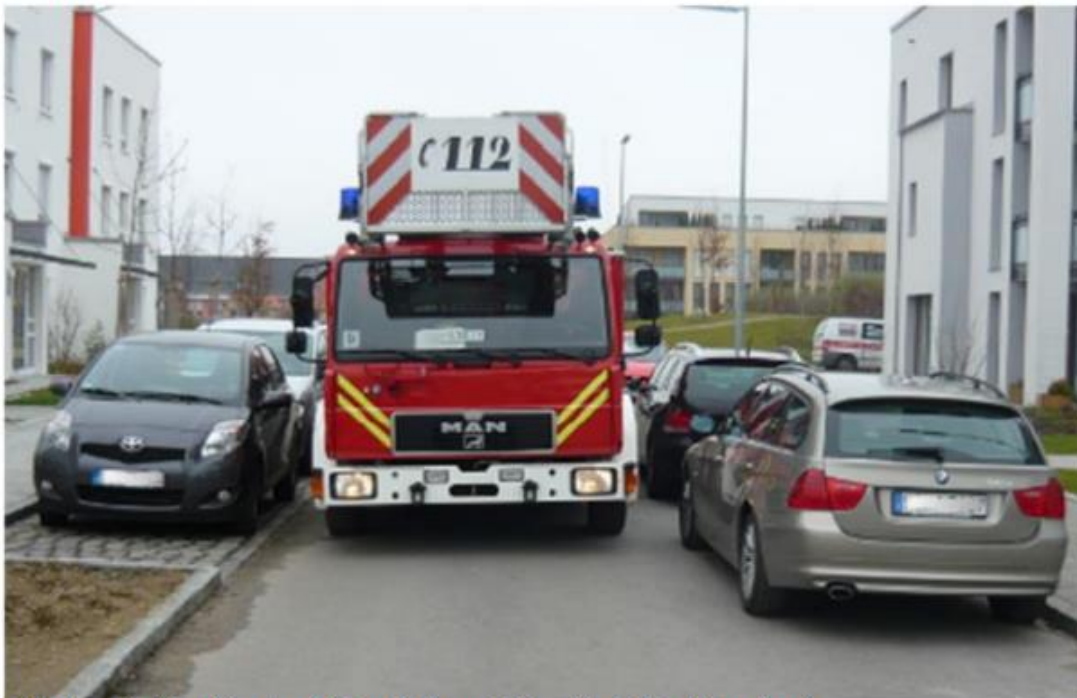
Behinderung im öffentlichen Bereich. Der Abstütz- und Schwenkbereich ist nicht vorhanden. Die Drehleiter kann nicht eingesetzt werden.
