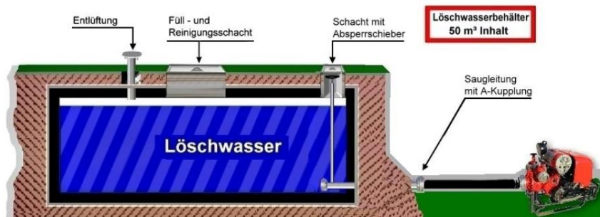
Beispiel : Löschwasserentnahmestelle "Unterirdischer Löschwasserbehälter"
