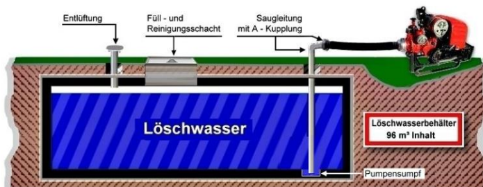
Beispiel : Löschwasserentnahmestelle "Unterirdischer Löschwasserbehälter"
